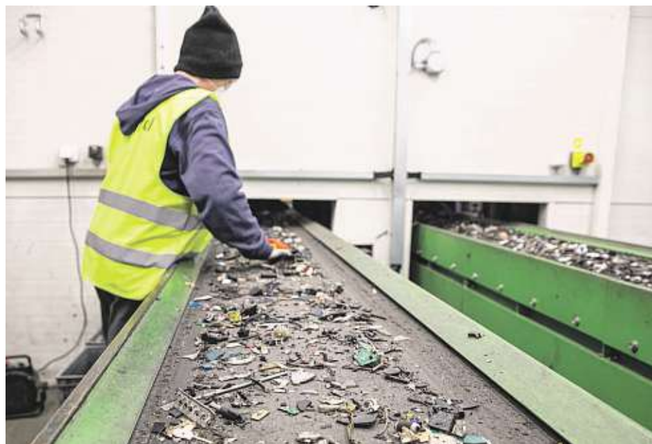
Ruční separace. Odpad se dále ručně třídí, vybírají se z něj třeba baterie, kabely, cartridge, pásky nebo další spotřebiče, které se pak zpracují zvlášť.
