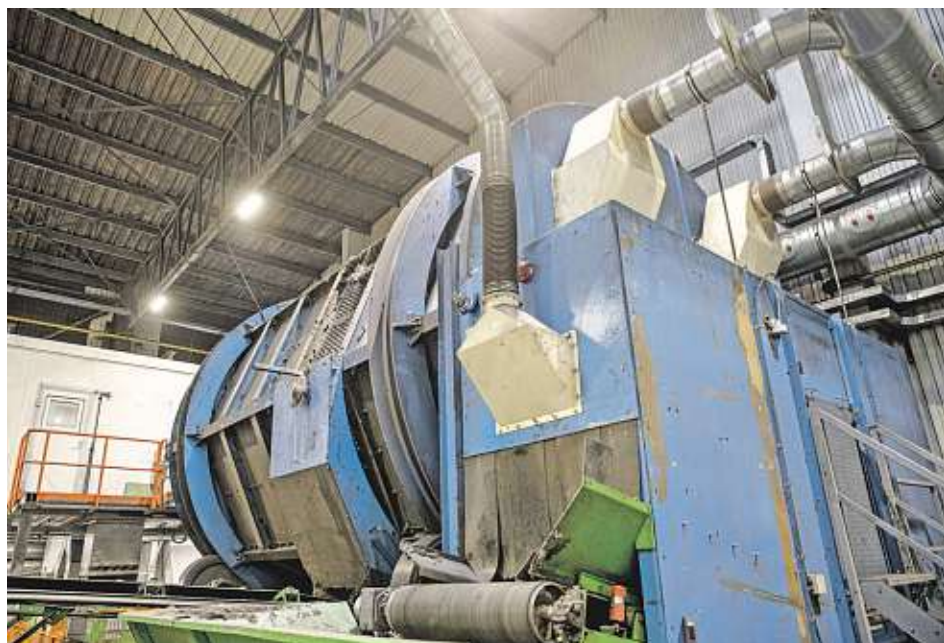
Jako v bubnu pračky. Jednou z prvních fází zpracování je rozbití spotřebičů v obřím smasheru, který funguje na principu rotujícího bubnu. Jednotlivé díly se tu oddělí.
