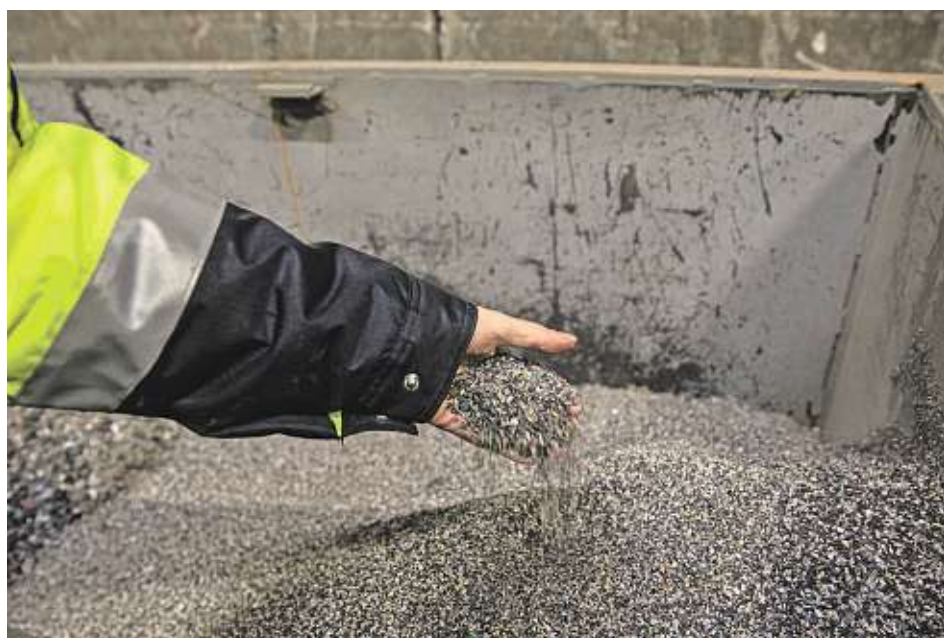
Zbude písek jemný i hrubý. Po zpracování se kovové části rozmělní a drtí, nakonec jsou z nich zrnka podobná písku, která putují do hutí. Tam z nich vzniknou další výrobky.
