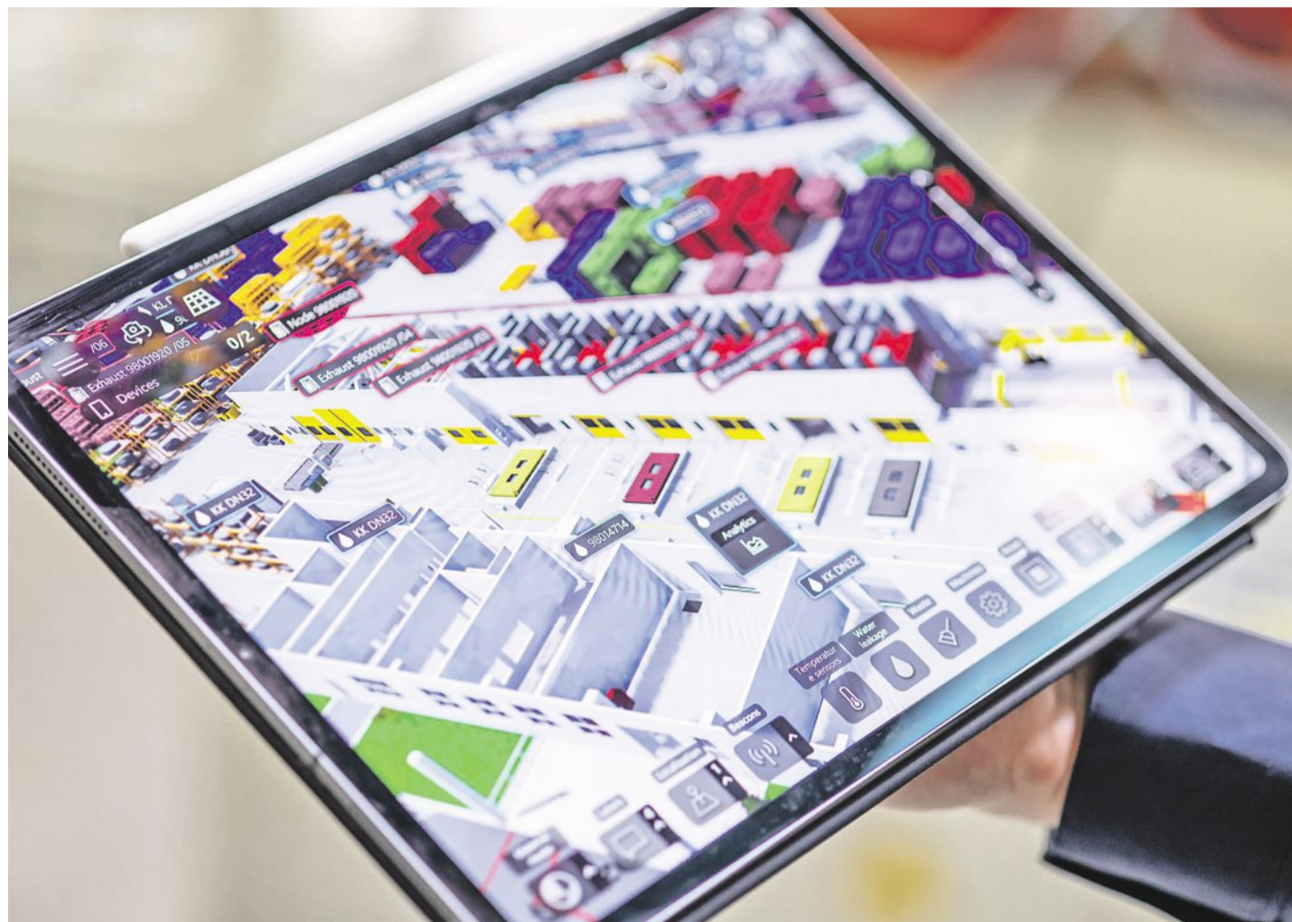
Informace hned a na jednom místě Digitální dvojče průmyslové budovy umožňuje nejen sledování nejrůznějších parametrů v reálném čase, ale i zaslání lokalizovaných notifikací – například „uniká voda v této části potrubí a přesně v této části haly“.
