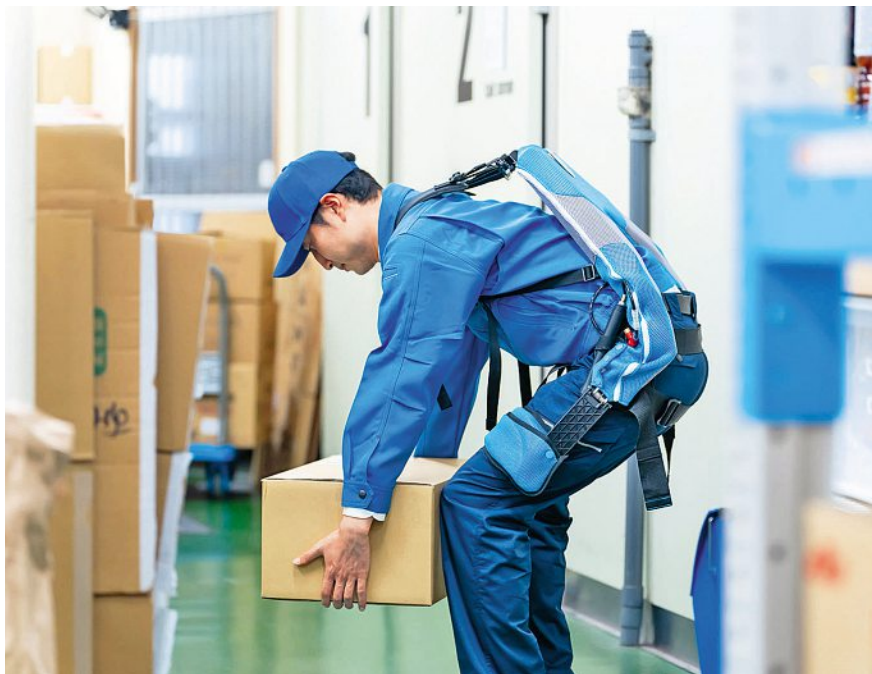
Exoskelety mají snížit náročnost některých manuálních úkonů v logistice a výrobě, ochránit zdraví lidí a aktivně předcházet úrazům a nemocem z přetížení svalového aparátu. Foto: Shutterstock
