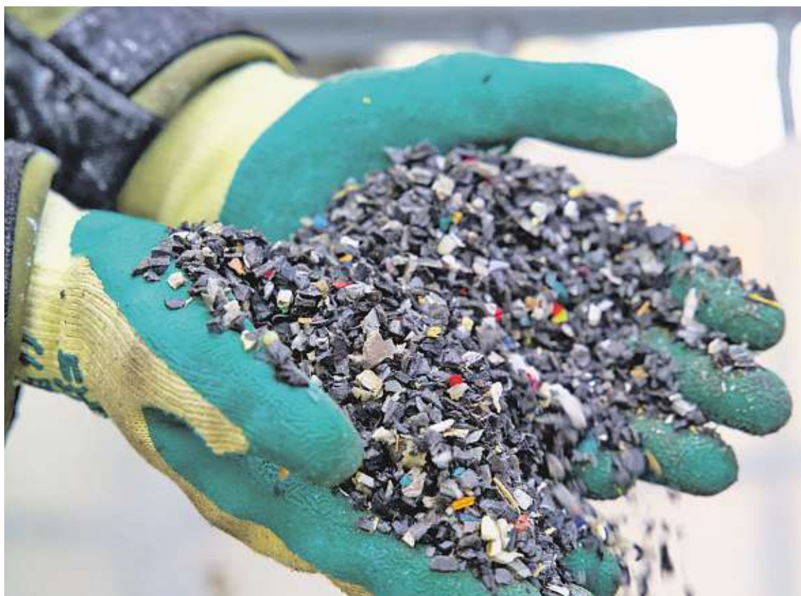
Nadrtit a poslat do druhého kola. Mechanická recyklace je proces, kdy se materiál nadrtí, ale neztrácí svou molekulární strukturu. Oproti tomu při chemické či tepelné recyklaci se materiál zcela promění.
