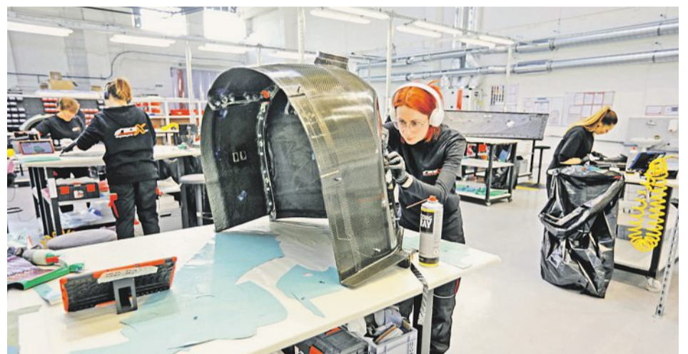
Řemeslná práce. Příprava dílů na vytvrzení v autoklávu probíhá ručně a vyžaduje maximální pečlivost. Pracovníci vkládají do forem kompozitní materiál z impregnovaných vláken a pak celé formy balí do vakuových pytlů. Ručně pak také ořezávají a zabrašují hotové díly. Foto: HN – Libor Fojtík
