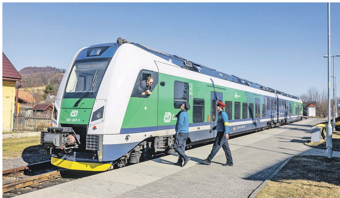
Dál už bez drátů. V úseku s trakčním vedením se bateriový vlak nabíjí z troleje a poté může dalších 80 kilometrů pokračovat po trati, kde elektrické vedení chybí.
