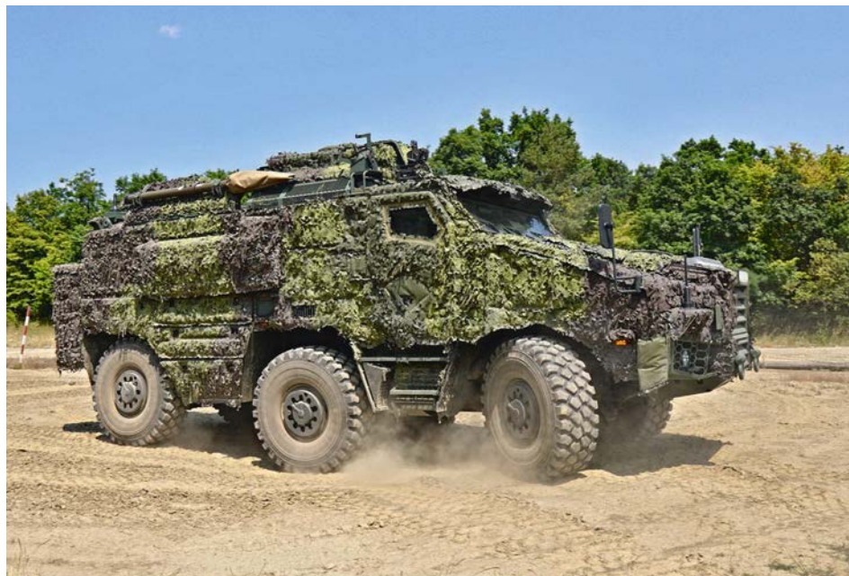
TITUS 6x6 patří do kategorie vozidel MRAV, jež se vyznačují silným pancéřováním a vysokým stupněm ochrany osádky. Foto: CSG
