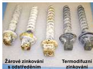
Vzorky po 2512 hodinách korozního testu v neutrální solné mlze dle CSN EN ISO 9227.
