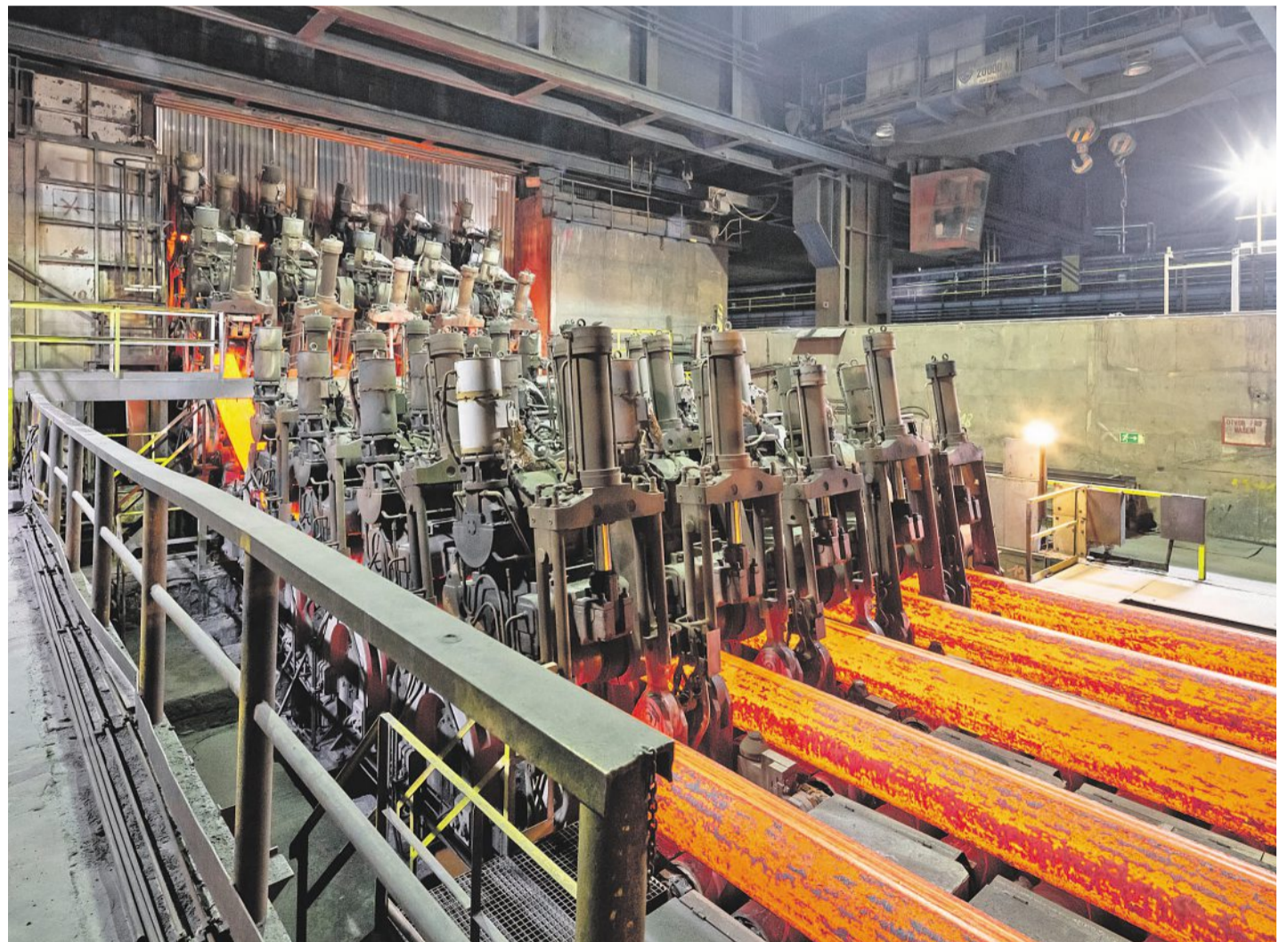
Kontinuální lité oceli. Před pěti lety Třinecké železářny zavedly technologii, která umožňuje vyrábět ocelové kontislitky o průměru až 600 mm. Polotovary slouží například pro součástky do větrných elektráren. Foto: Třinecké železářny
