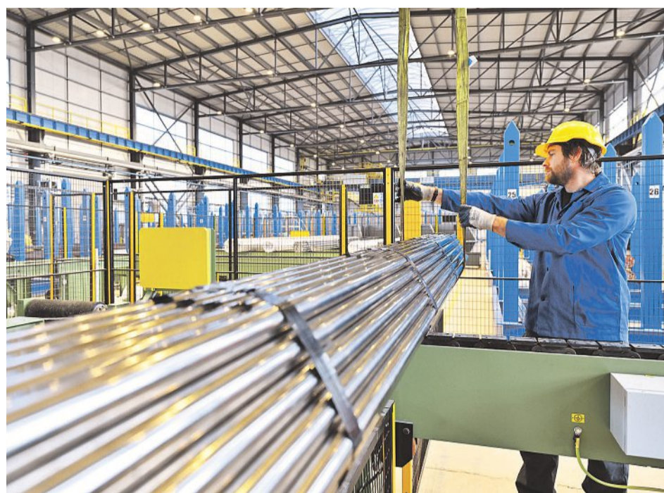
Investice do budoucnosti. S přesností na setiny milimetru a bez povrchových vad vyjíždí z nové loupací linky Třineckých železáren ocelové tyče průměru 30 až 80 milimetrů. Foto: Třinecké železářny
