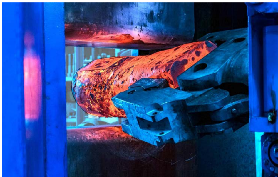
Žhavé ingoty Výklovky mají oproti litým materiálům či dílům vyrobeným 3D tiskem vyšší pevnost. V oddělení metalurgické technologie dokážou pracovat i s rozměrnými ingoty. Foto: Comtes FHT
