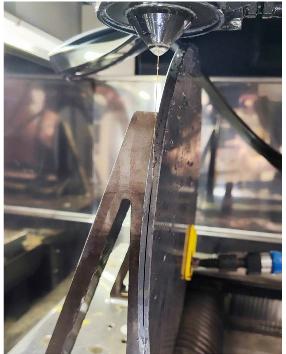
Experimentální pracoviště na Fakultě strojní VŠB-TUO při přípravě zkoušek dezintegrace polovodivé keramiky pomocí elektroerozivního drátového řezání
