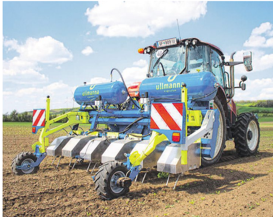
Chytrá plečka plevel nevytrhává. Pomocí nožů podrývá půdu a tím plevelu narušuje kořínky. Foto: archiv firmy Ullmanna
