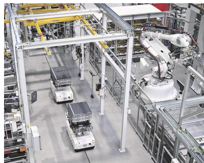
Nákladňky na baterky. Scania chce do roku 2030 prodávat polovinu svých aut s elektrickým pohonem. Na kompletaci baterií z článků od firmy Northvolt otevřela ve výrobním závodě v Södertälje novou halu. Kompletace modulů je plně automatizovaná.
