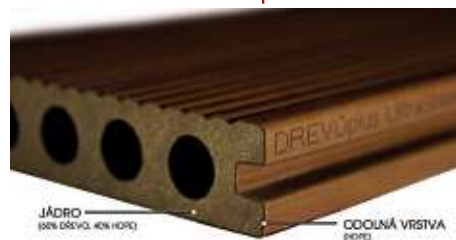
Detail složení materiálu DŘEVO plus ® PROFI UltraShield®
