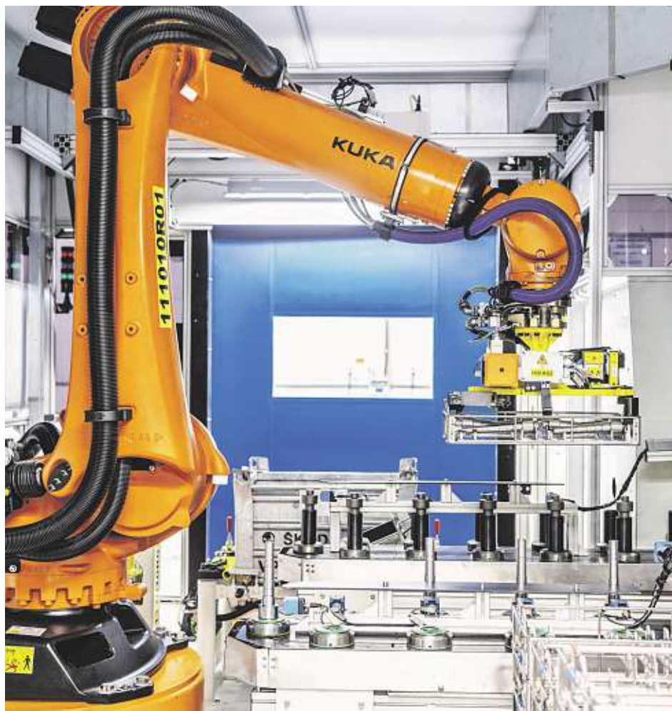
Chytrý manipulační robot ve vrchlabském závodě Škody Auto – na základě obrazu z kamery algoritmus stanoví, který z dílů je pro uchopení chapačem robota optimálně dosažitelný, a propočítá potřebné pohyby. Robot pak položí surový díl na dopravník obráběcího stroje a po obrobení jej zase odebere, aby ho uložil do přepravního obalu.
