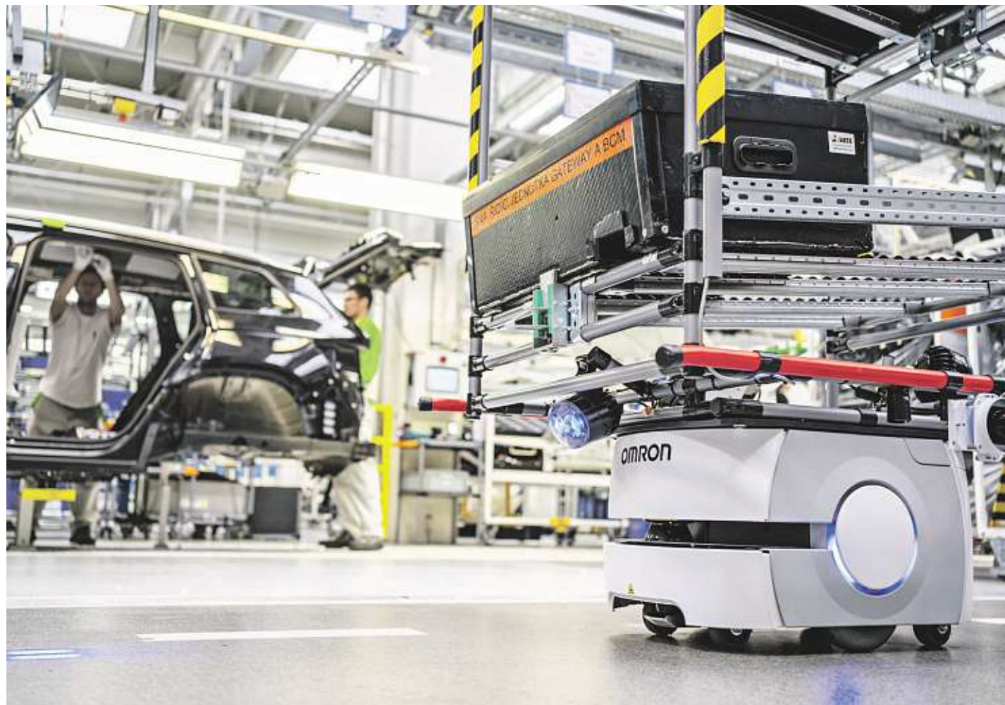
AGV ve výrobě – Škoda Auto v Kvasinách využívá moderního autonomně řízeného transportního robota, jenž si sám naplánuje nejefektivnější trasu do cíle a cestou rozpoznává překážky. Jeho maximální nosnost činí 130 kilogramů. Foto: Škoda Auto
