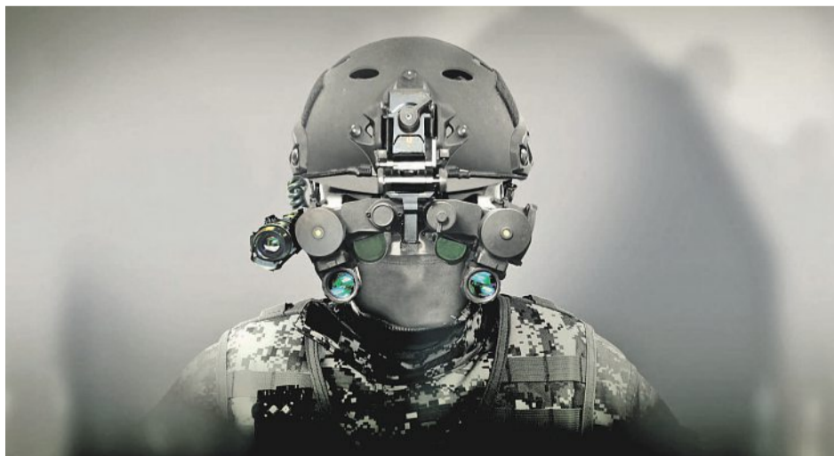
Brýle pro noční vidění patří dnes již ke standardní výbavě příslušníků speciálních jednotek. Zdroj: GLOMEX MS
