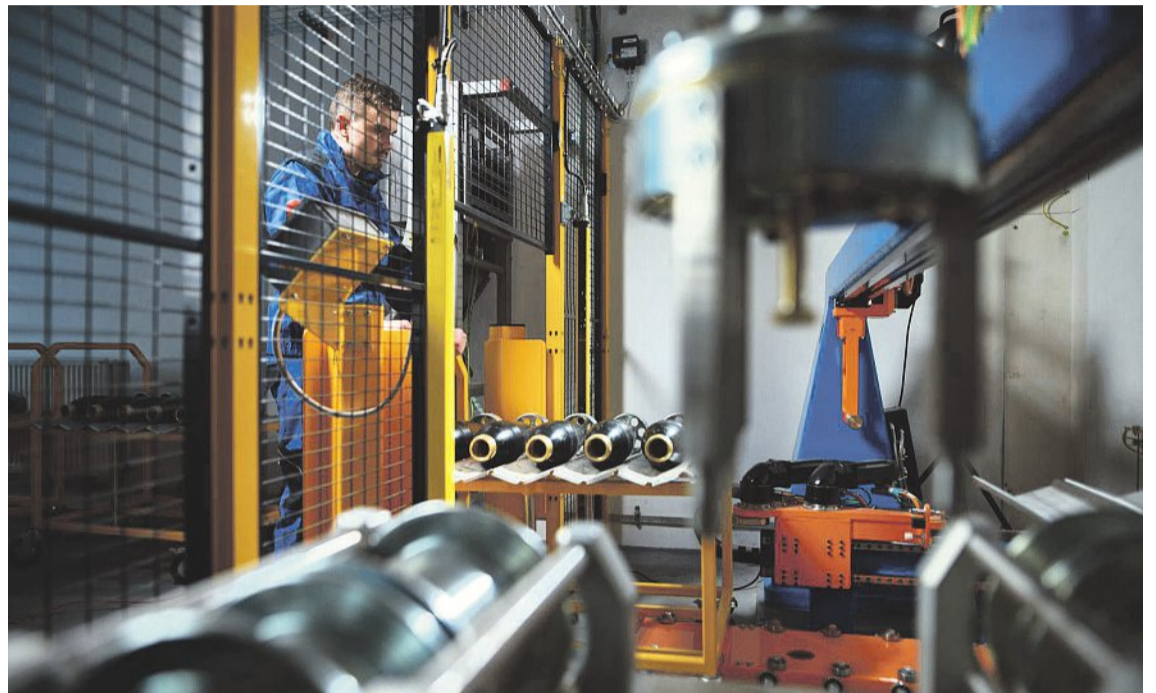
Linka pro výrobu munice. Společnost STV Group ve výrobním závodě v Poličce vloni spustila vysoce automatizovanou linku na plnění velkorážových dělostřelečných, tankových nebo minometných granátů trhavinou. Foto: STV Group
