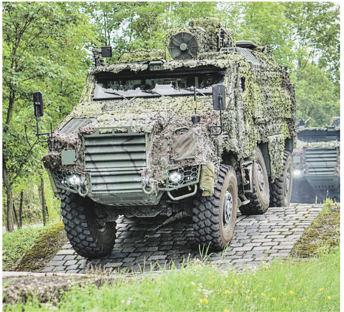
Víceúčelový obrněnec. Tatra Defence Vehicle pro českou armádu ve spolupráci s Tatrou a francouzskou Nexter Systems vyvinula a vyrábí pancéřovaná vozidla TITUS na podvozku kopřivnického výrobce. Foto: CSG
