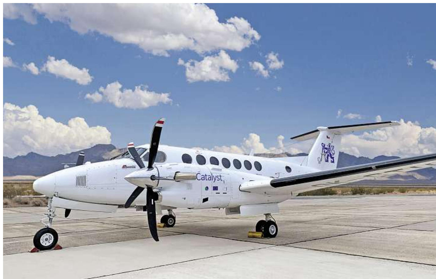
Turbopropový motor Catalyst absolvoval v září loňského roku úspěšnou premiéru ve vzduchu v testovacím letounu Beechcraft King Air 350, létající zkušebně Fakulty strojní ČVUT.
