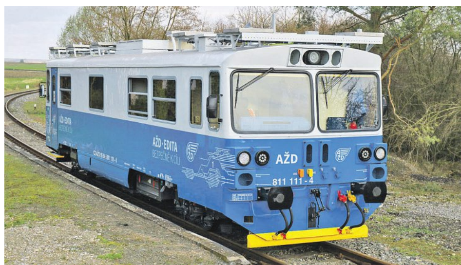
Autonomní vozidlo EDITA (Experimentální Drážní vozidlo pro Inovativní Technologie AŽD), postavené na platformě motorového vozu řady 810.
