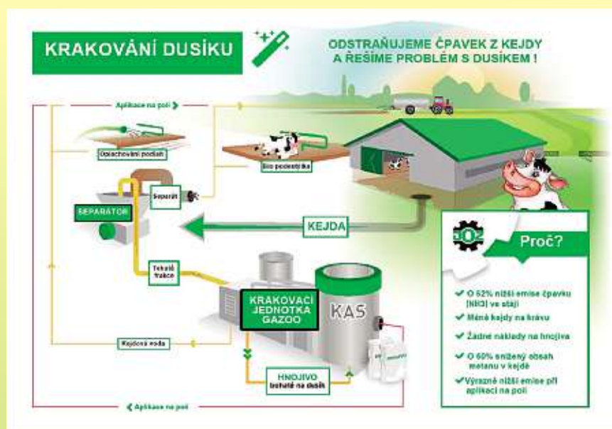
Schéma zapojení GAZOO do provozního cyklu farmy
