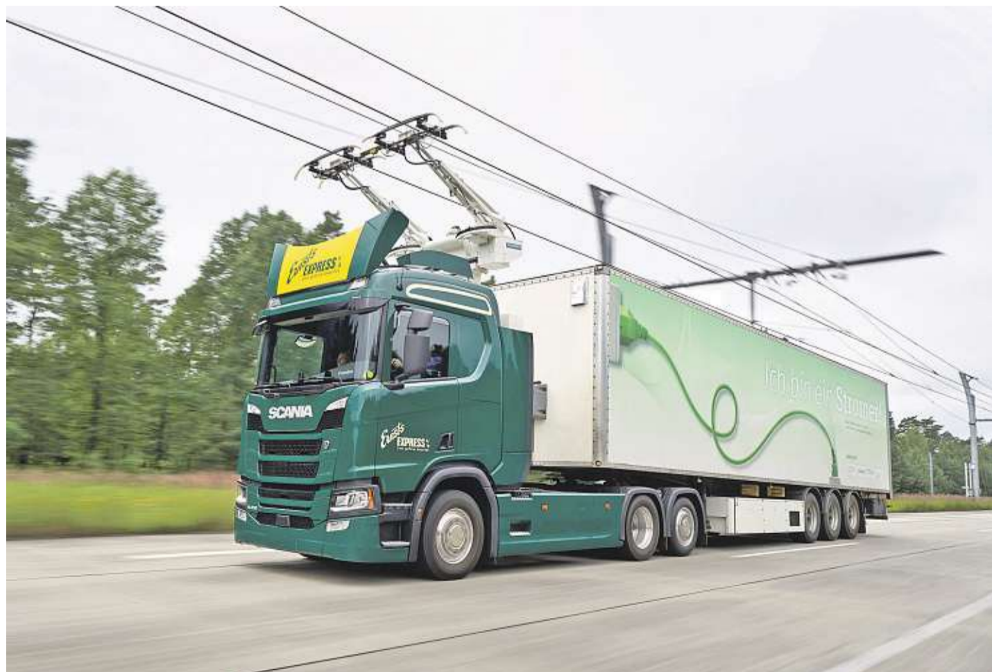
Elektrifikace na dálnicích. Kamiony jezdí jako trolejbusy, energii čerpají z elektrické sítě vedené nad dálnicí. V Německu je testují, u nás je považujeme za slepou uličku. Foto: Scania
