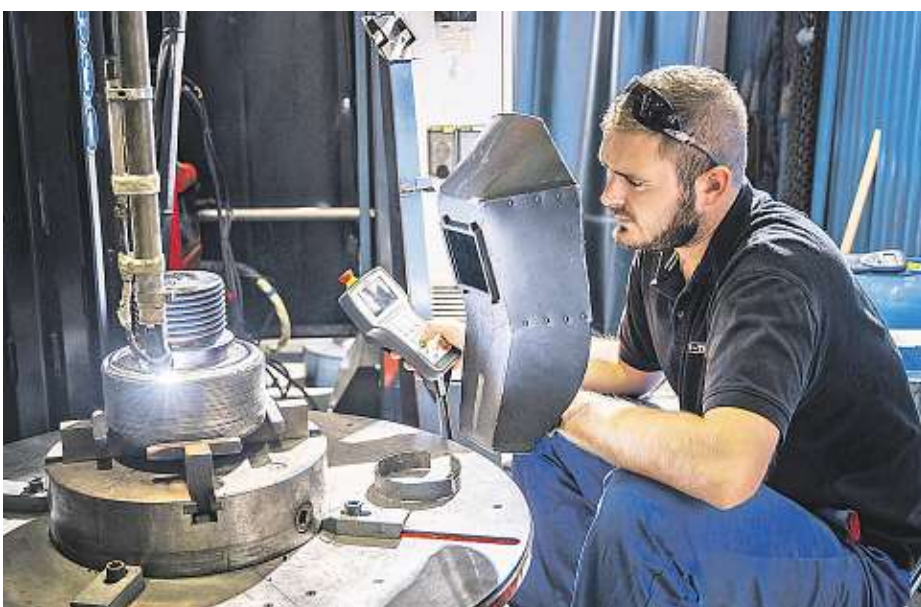
Když je téměř každý výrobek v podstatě originál, nestačí jen mechanicky mačkat tlačítka a spoléhat na program, kterým je stroj řízen. V tomto případě operátor kontroluje průběh navařování materiálu na protlačovací hlavu lisu.
