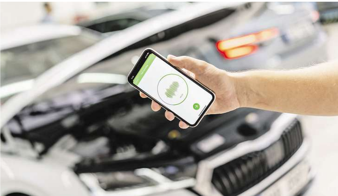
Škoda Auto Digilab vyvinula aplikaci Sound Analyser pracující na principu neuronových sítí. Program nahraný zvuk auta převede do grafické podoby spektrogramu, porovná s uloženými hodnotami a odhalí odchylky. Foto: Škoda Auto
