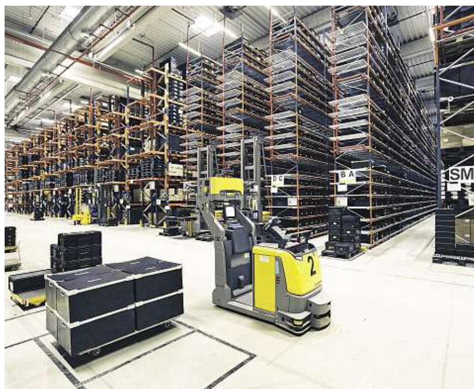
Automatické vedení. V uličkách výškového regálového skladu jsou zakladače řízené automaticky, pomocí indukčního vedení v podlaze.
