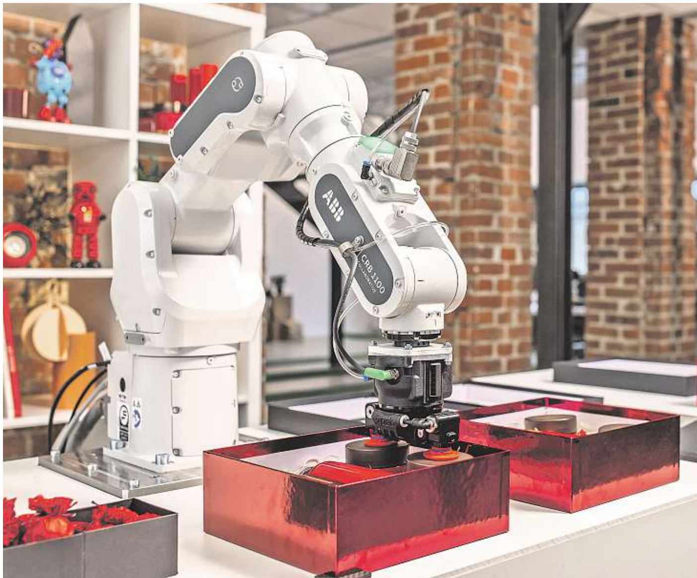
Rychlý i kolaborativní. Kobot řady Swifti od firmy ABB dokáže pracovat rychle jako průmyslový robot, ale může i spolupracovat s člověkem. Dokáže detekovat přítomnost člověka ve svém pracovním prostoru a automaticky zpomalit či úplně zastavit svůj pohyb. Foto: ABB
