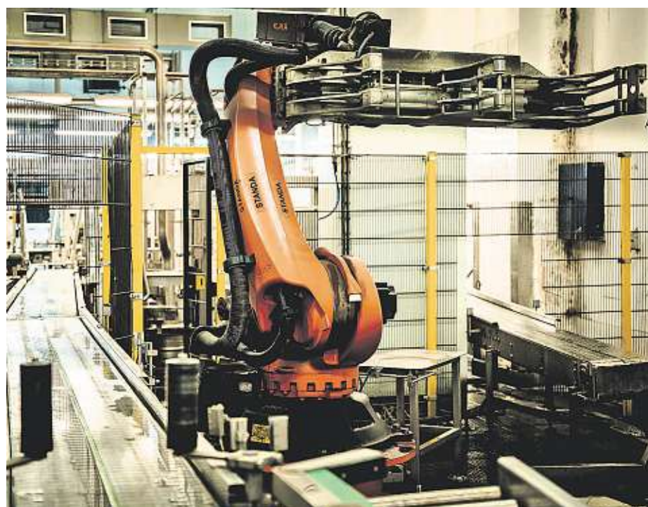
Standa a Pepa Roboti Standa a Pepa pomáhají v pivovaru Bernard s paletizací a depaletizací sudů. Standa pracuje s prázdnými sudy, Pepa s plnými. Foto: Rodinný pivovar Bernard
