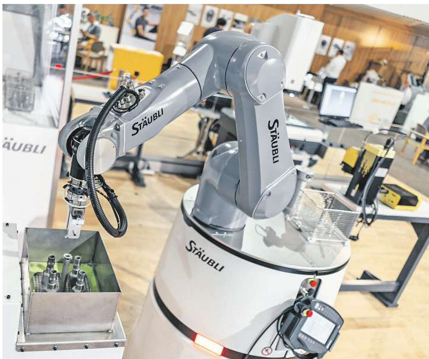
Mobilní roboti jsou budoucností robotiky. Robotické rameno na autonomním vozíku, který se sám pohybuje po pracovišti, představuje robot HelMo společnosti Stäubli Robotics.
