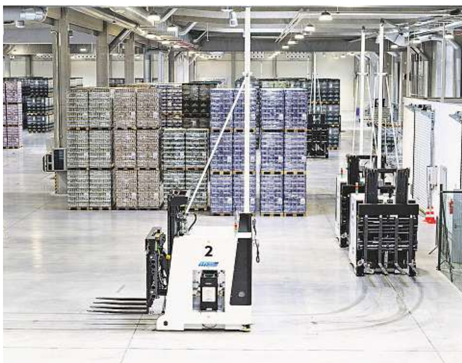
Robotizované vysokozdvizné vozíky v centrálním skladu Radegastu v Nošovicích zvládnou prakticky všechny operace ve skladu kromě nakládky a vykládky kamionů. Foto: Plzeňský Prazdroj
