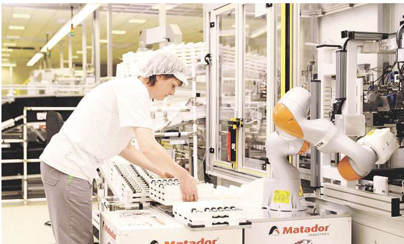
Pro lehčí práci. Nosnost současných kolaborativních robotů se pohybuje přibližně od půl kilogramu do deseti kilogramů, v některých případech mírně více. Hmotnost samotného robota je v nižších desítkách kilogramů. Foto: Kuka Robotics
