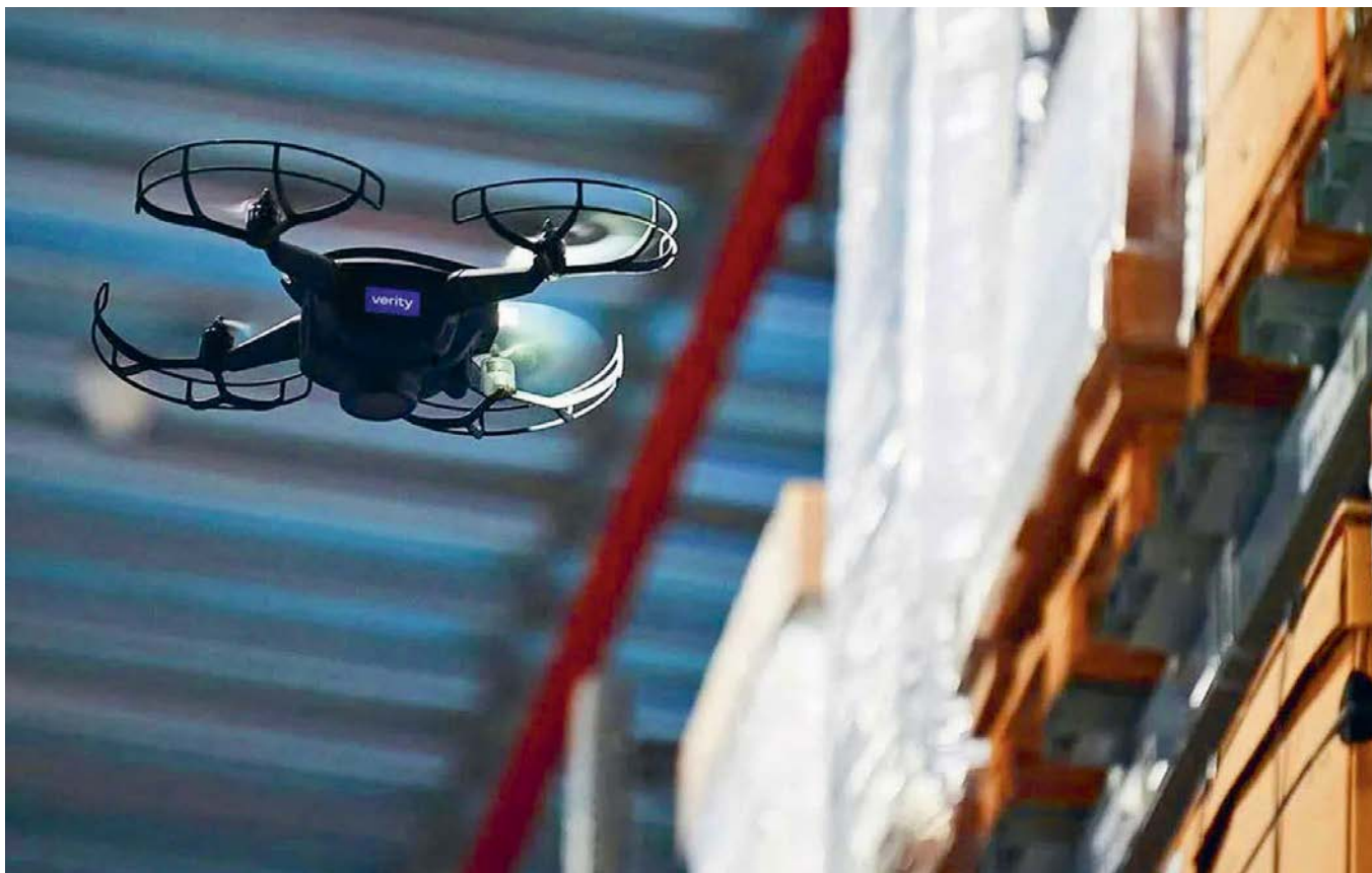
Během inventury drony skenují RFID tagy či čárové kódy od úrovně podlahy až po nejvyšší regál, dokážou skenovat poškozené a obtížně čitelné čárové kódy a identifikovat prázdná místa.
