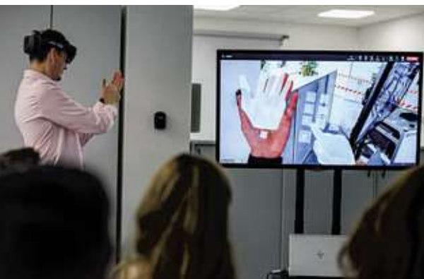
Zdeněk Chalupa předvádí, jak brýle s funkcí rozšířené reality umožňují uživateli různě manipulovat s vybraným 3d modelem. Ten tak lze uchopit, rozebrat, zvětšit.
