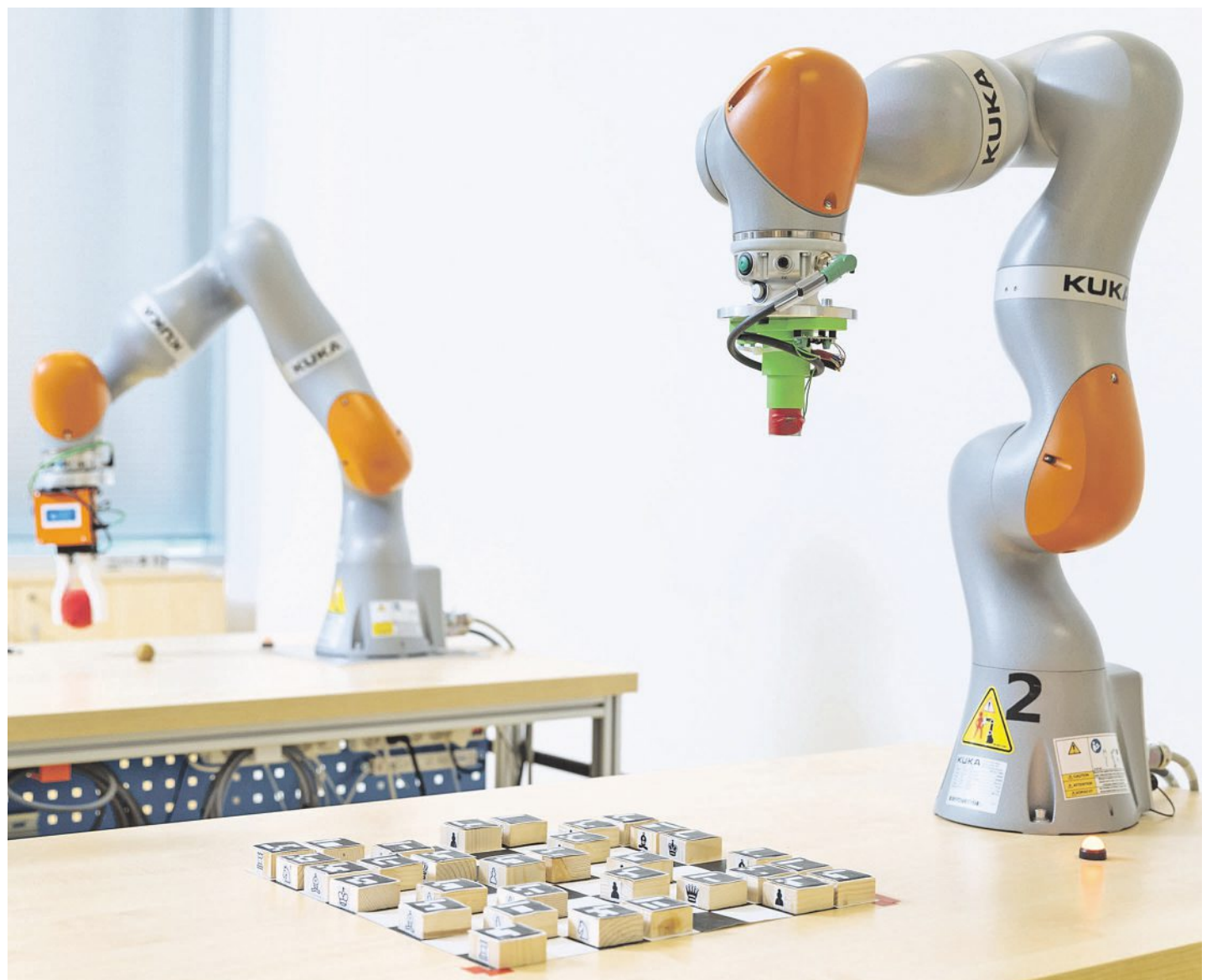
Strojové učení Roboty z CIIRC využívají kamery ke strojovému vidění, díky čemuž se učí manipulovat s předměty téměř jako člověk. Foto: HN – Lukáš Bíba
