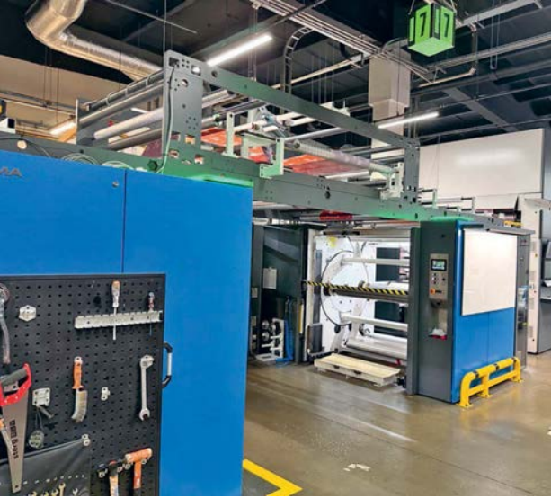
Tisk na českých strojích SOMA. Flexotiskové linky vyráběné v Lanškrouně patří ke světové špičce a jsou standardem ve výrobních halách.
