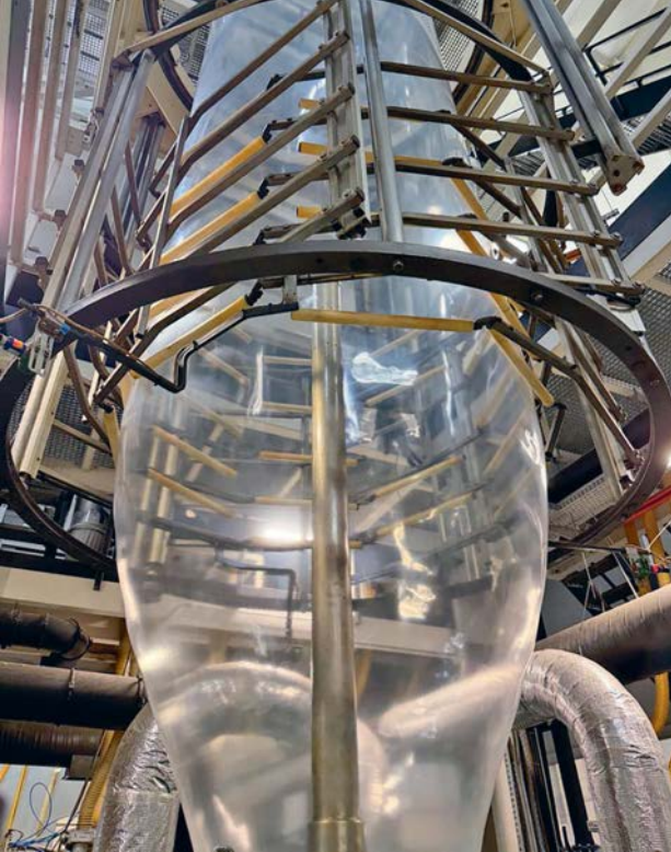
Výroba PE fólie metodou vytlačování, základ pro MDO a bariérové materiály, které tvoří stoprocentně recyklovatelný obal.
