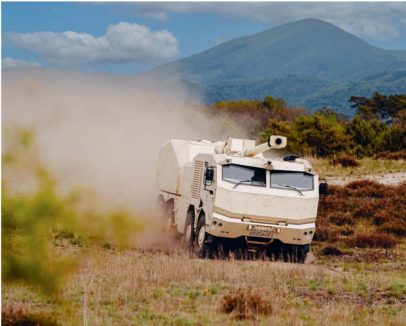
Samohybná houfnice Morana využívá automatický nabíjecí systém, který umožňuje vypálit šest ran během první minuty a při dlouhodobější palbě udržet kadenci pěti ran za minutu.
