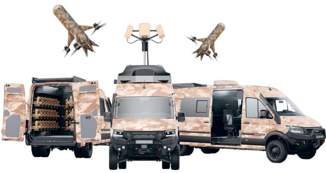
Mobilní protidronový systém Murmus sestává z velitelského a bojového stanoviště. Velitelské vozidlo nese radar na teleskopickém stožáru, dvě úderná vozidla vezou záchytné drony, celek doplňuje síť senzorů. Zdroj: S-Tech Group
