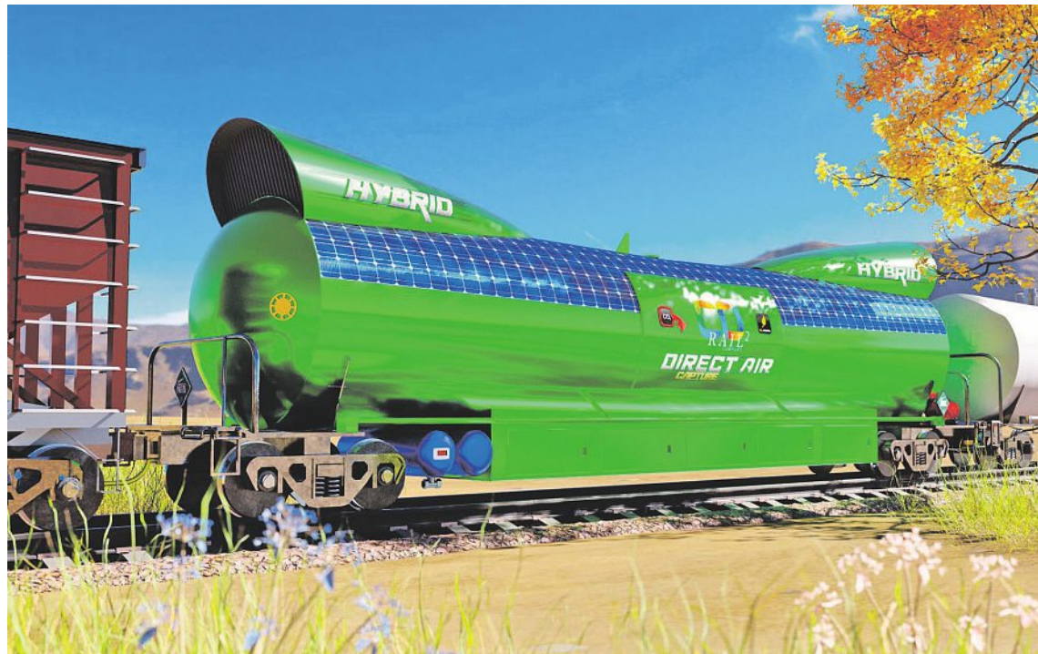
Vlak, který čistí vzduch. Vůz CO2Rail může z atmosféry odstranit devět tun oxidu uhličitého denně.
