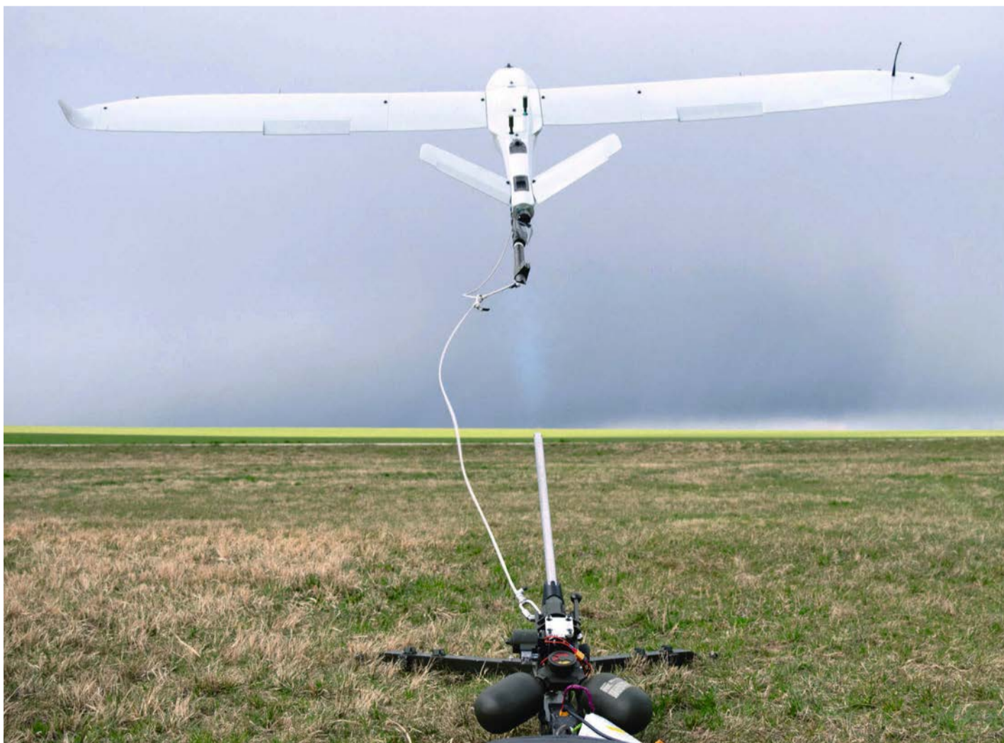
Z ptáčích perspektiv Významným výrobcem průzkumných i útočných dronů v Česku je firma U&C UAS. Měsíčně vyrobí mezi 100 až 300 kusy. Na snímku je průzkumný model Stork LR při startu z pneumatického katapultu. Foto: U&C UAS
