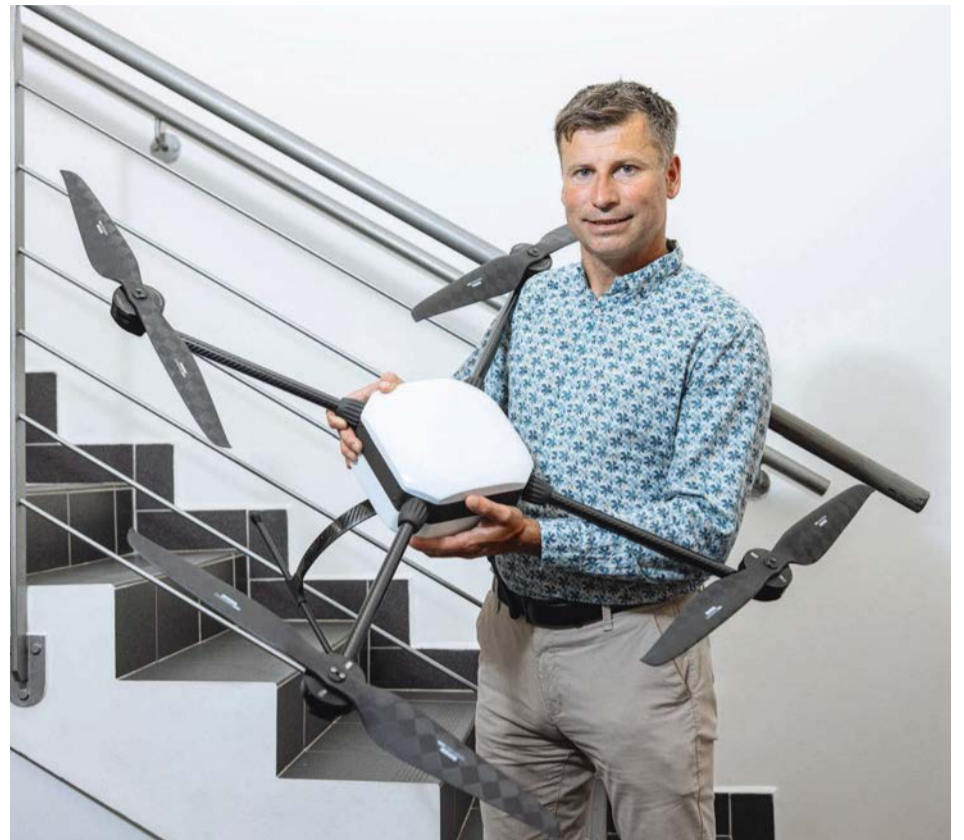
Modulární platforma Autonomní dron F4F RoboCore s výměnnými rameny je konstruován s maximální univerzálností pro nejrůznější mise, ukazuje profesor Martin Saska. Foto: HN – Lukáš Bíba
