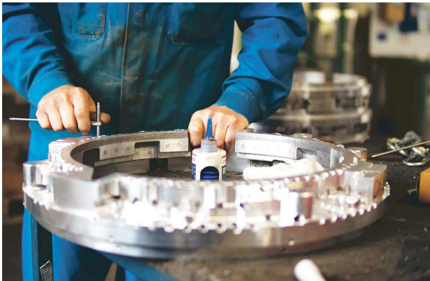
Úspora času ve výrobě Ve společnosti Ingmetal se podařilo díky využití systému Vericut zrychlit nebo vyhladit dráhu obráběcích nástrojů a tím zkrátit dobu obrábění. Foto: Ingmetal
