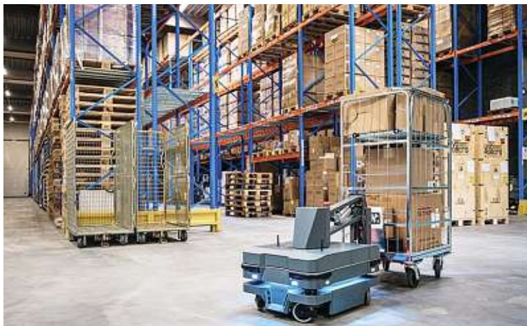
Na ilustračním snímku je robotické vlečné zařízení MiR250 Hook. Foto: Mobile Industrial Robots (MiR)
