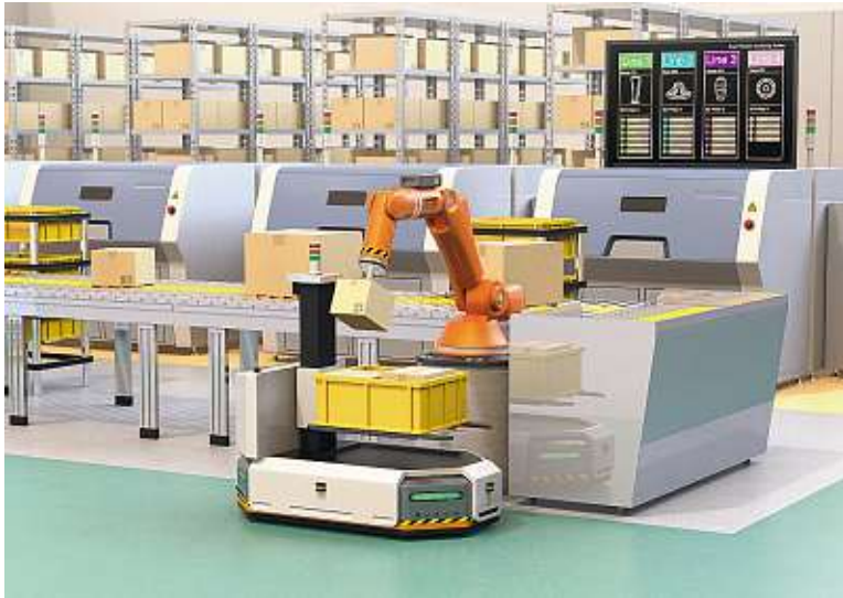
Jde to i bez lidí – automatizovaný vozík přiváží ze skladu přepravku s vychystanými položkami, které odebrá robotická ruka a pokládá je na pás.
