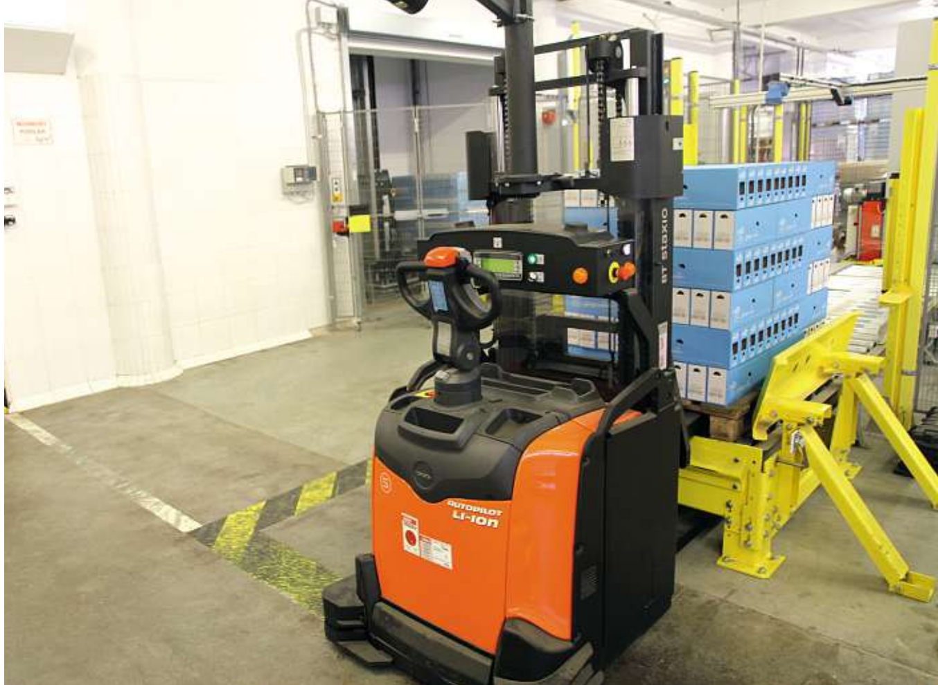
Automatizovaný vozík Toyota zakládá paletu na válečkovou dráhu v závodě Linea.
