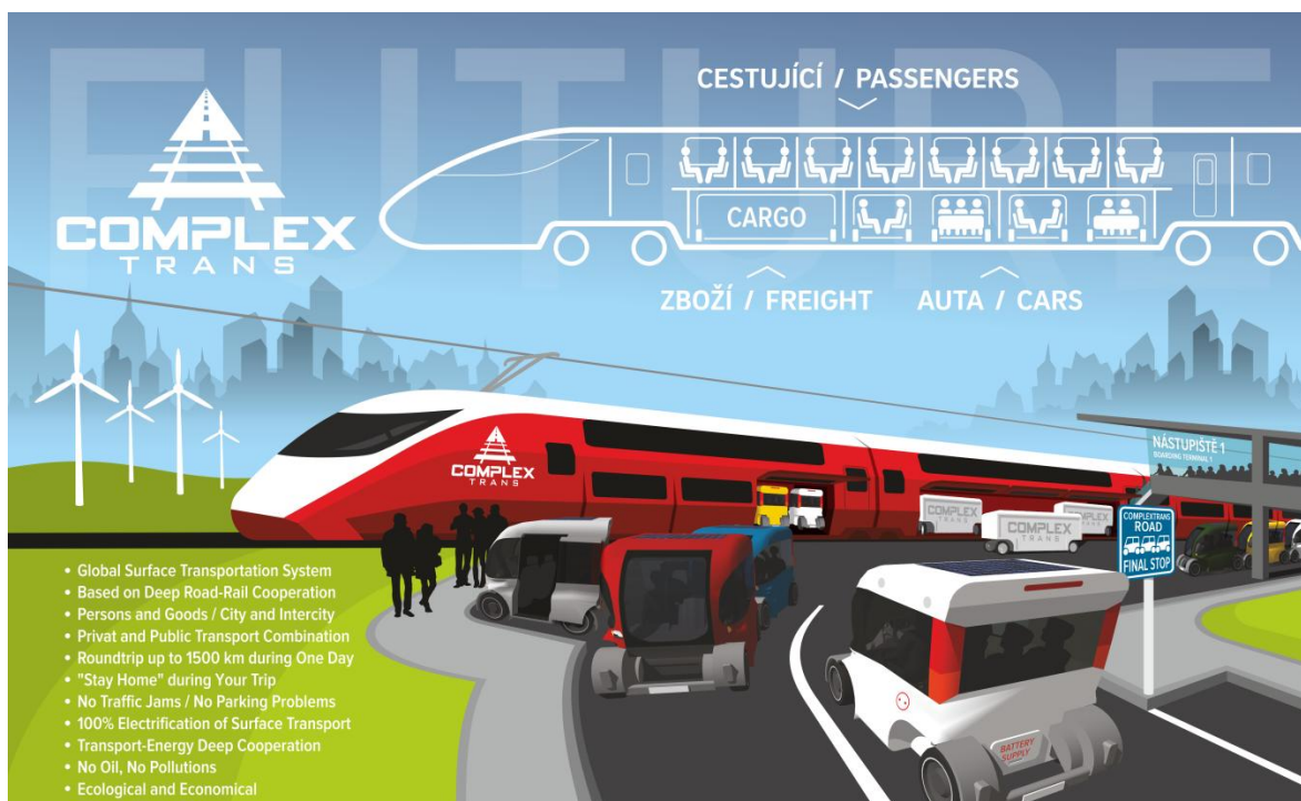
OBR.1 - nástupiště systému ComplexTrans – výměna cestujících (horní patro) a nakládka a vykládka osobních automobilů a nákladních přepravních modulů (dolní patro) do vlaku ComplexTrans
