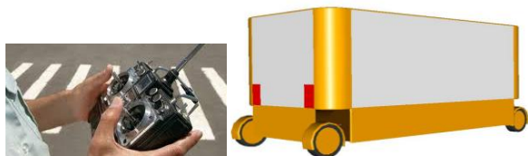
OBR.22 – k lokální manipulaci nákladního přepravního modulu slouží dálkové ovládání
