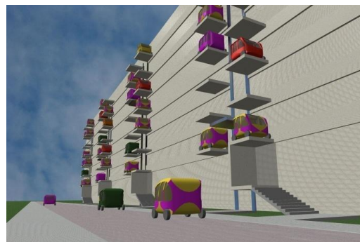
OBR.15 – vícepatrové obytné i administrativní budovy budou opatřeny balkóny pro parkování kupémobilů, kam budou zdvihány pomocí výtahů přemístěných ven. Bude tak zaručeno vždy bezpečné parkovací místo a snadné nakládání a vykládání. Kupémobil i se svými technologiemi bude moci být využíván jako další místnost.
