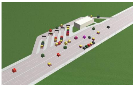
OBR.17 – kupémobily se budou moci spojovat též mechanicky do těsných souprav pomocí spřáhla umístěného na výsuvných nápravách. Ke spojování kupémobilů jedoucích stejným směrem jsou určeny např. seřazovací terminály s několika rozřazovacími pruhy.
