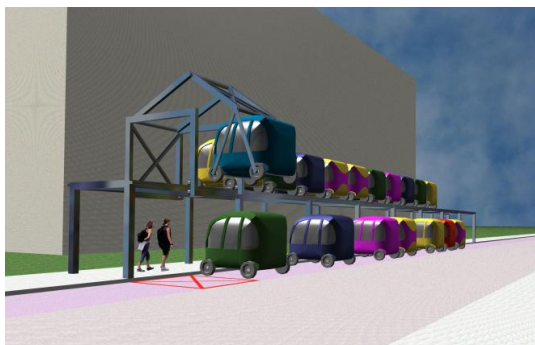
OBR.13 – díky kompaktnímu tvaru a úchytům ve střeše budou moci být kupémobily parkovány ve speciálních parkovacích zařízeních nad chodníky.
