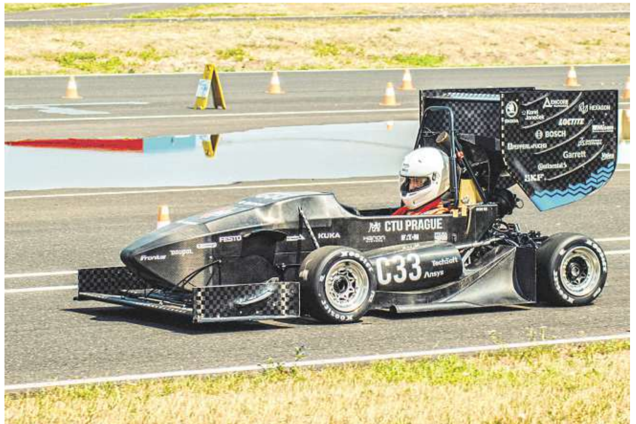
První závodní hybrid od studentů. Tým CTU CarTech představí první hybridní studentskou formuli. Kromě spalovacího motoru ji pohánějí také dva elektromotory na přední nápravě. Na strojírenském veletrhu bude k vidění pouze staticky, na výstavní ploše. Foto: ČVUT
