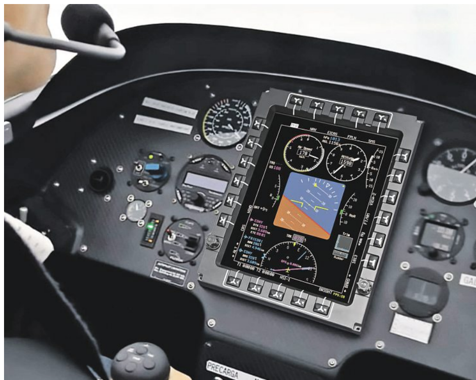
Multifunkční displej EFIS umožňuje zobrazení všech údajů o letadle a jeho subsystémech na jedné obrazovce. Foto: LPP
