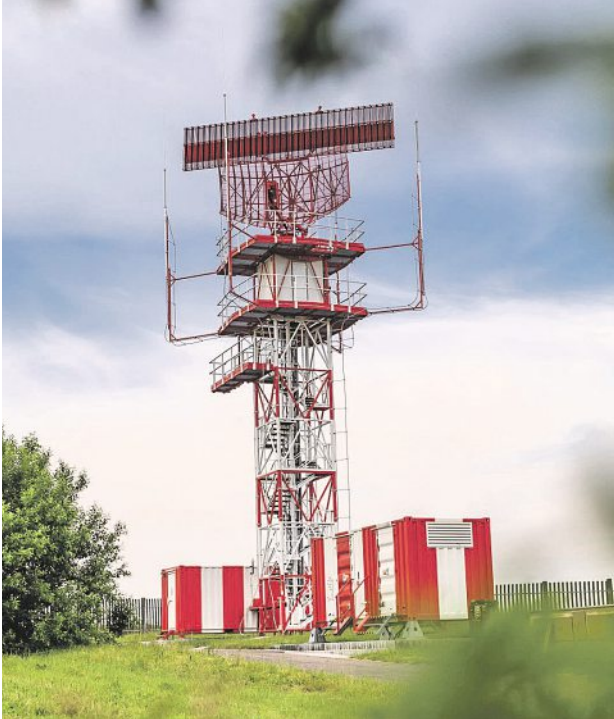
Přenosný radar ReTwis 5+ je schopen detekovat a sledovat osoby a živé bytosti za nekovovými překážkami (nahore). Primární přehledový radar RL-2000 v kombinaci s monopolzním sekundárním přehledovým radarem MSSR-1 (vlevo)
