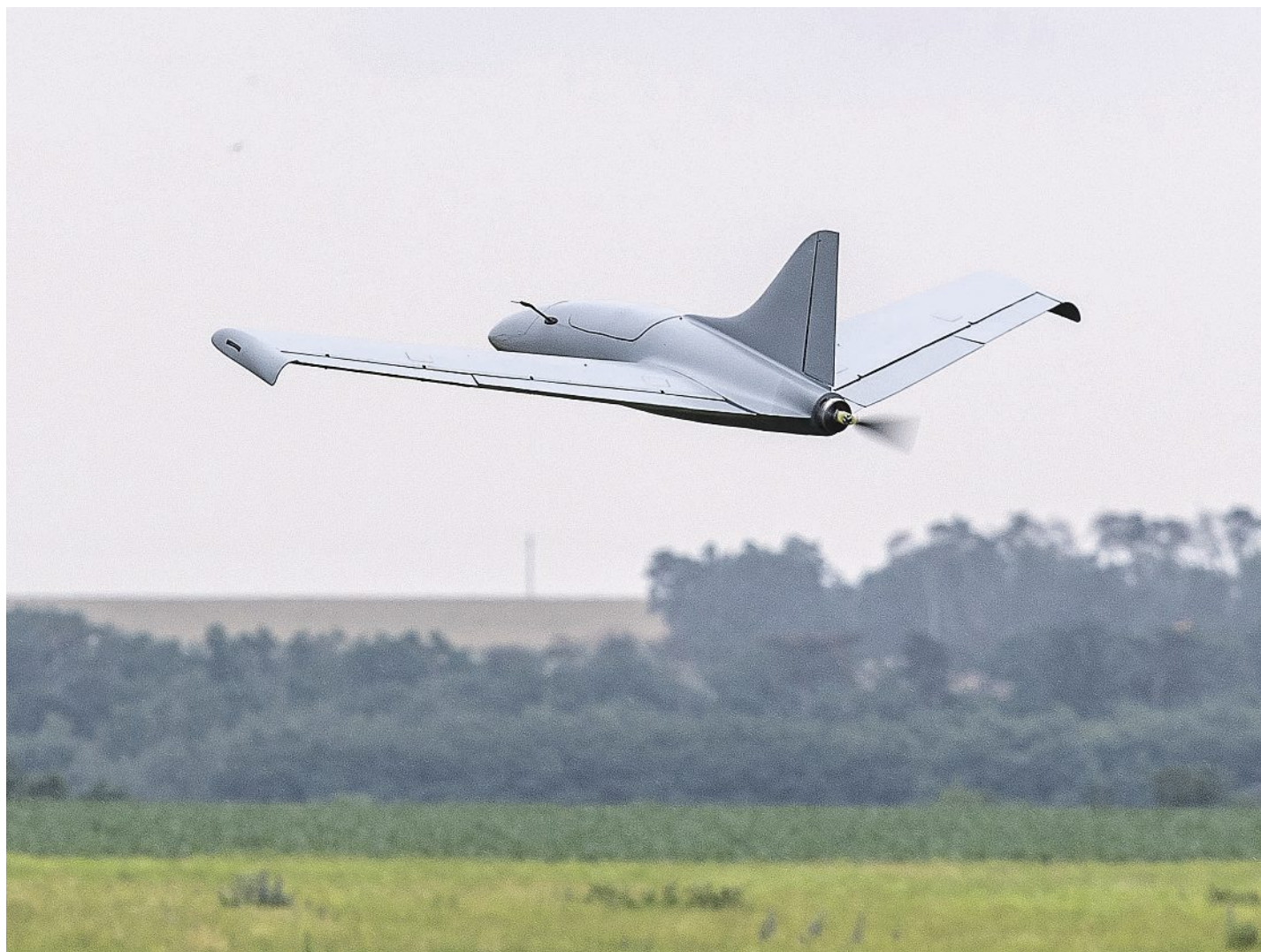
V Česku vznikl prototyp bezpilotního letounu Bivoj, který váží 25 kg, rozpětí křídel má 3,3 m a unese náklad o hmotnosti až 8 kg.
