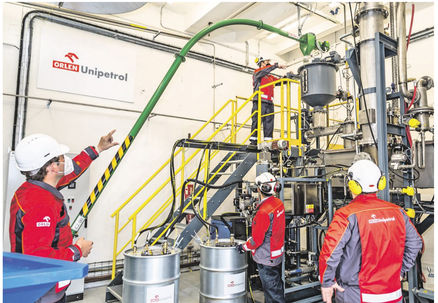
Testovací jednotka Orlen Unipetrol zkouší v Litvínově už tři roky termochemický rozklad plastů různého složení. Získává tak know-how pro budoucí velkoobjemovou jednotku s kapacitou zpracování až 30 tisíc tun plastového odpadu ročně. Foto: Orlen Unipetrol
