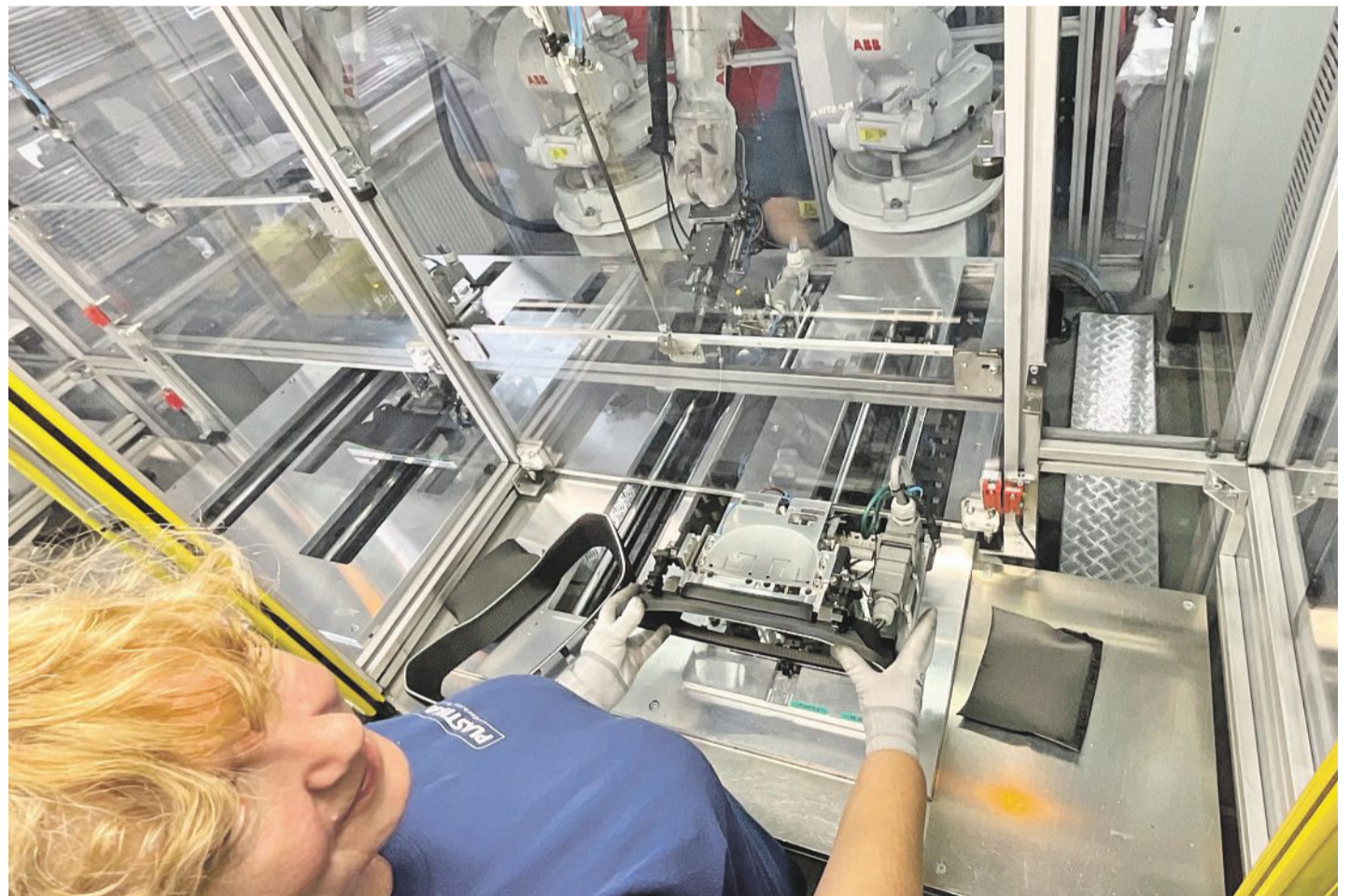
Bezpečná spolupráce. Operátor bývá od robota oddělen fyzickou zábranou, společný prostor montáže může být navíc hlídán infračervenými čidly, která znemožní operátorce sáhnout do probíhající operace. Její úlohou je pak vizuální kontrola dílu a uložení do připraveného obalu. Foto: Plastika
