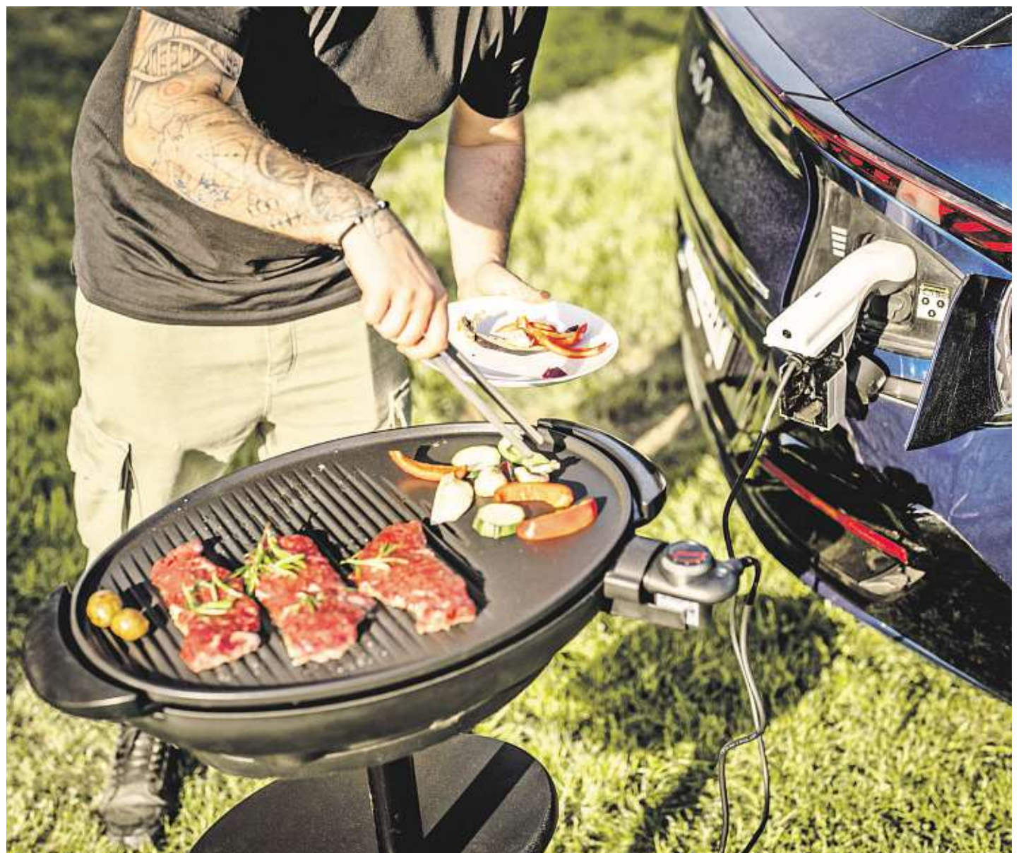
Energie pro gril – Jedním z příkladů využití funkce V2L může být kempování, kdy díky elektromobilu bude možné napájet gril, elektrický vaříč, konvici, venkovní osvětlení, dobíjet mobilní telefony či notebooky nebo se třeba dívat na televizi.
