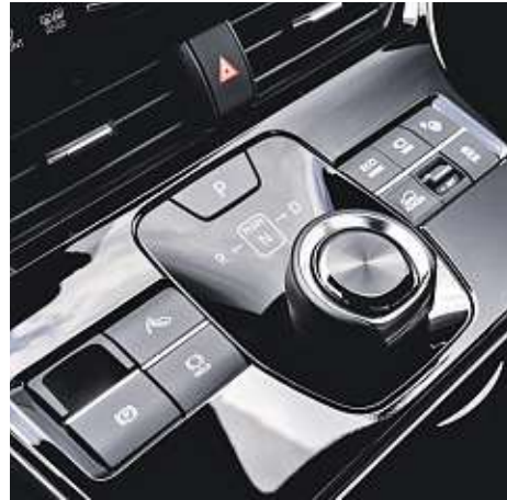
Lesklá plocha s ovladači klimatizace pod obrazovkou se rychle upatlá (vlevo). Jízdní volič je příjemný na dotek. K přeřazení je potřeba ho zatlačit a otočit vybraným směrem (vpravo). Foto: Toyota
